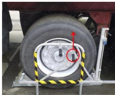
Ist der Double Chock K/KL korrekt arretiert, kann der Schlüssel gegen den Uhrzeigersinn gedreht und entnommen werden. Beim Drehen des Schlüssels wird der Keil in seiner Einstellung verriegelt.
