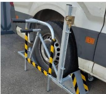
Ist der Double Chock K/KL richtig angebracht, umfasst er lose das zu sichernde Rad. Ziehen Sie den Arretierungshebel nach oben. Der Keil fährt zusammen und sollte das Rad möglichst formschlüssig umgreifen.
